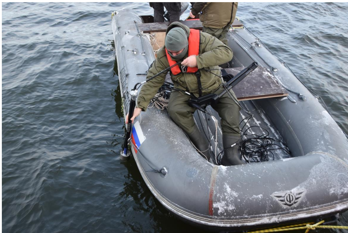
Илл. 27. Морской отгрузочный терминал. Участок «Створы». Уточнение места аномалии градиентометром Ferex 4.035API.
