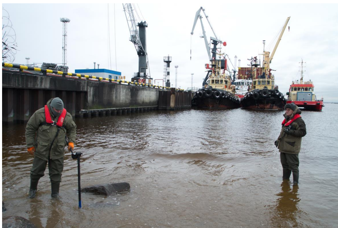
Илл. 30. Морской отгрузочный терминал. Участок МОТ. Магнитометрическое обследование прибрежной зоны градиентометром Ferex 4.035API
