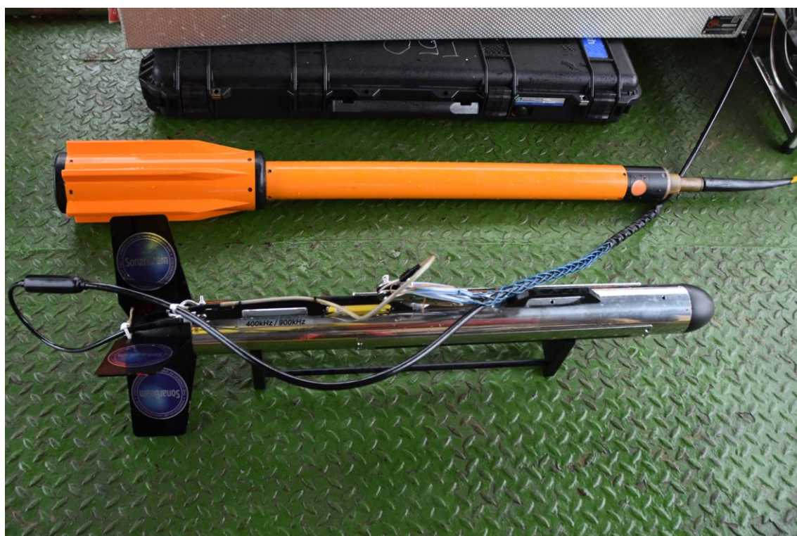
Илл. 15. Морской отгрузочный терминал. Буксируемые устройства «рыбы» магнитометра и гбо (на переднем плане).
