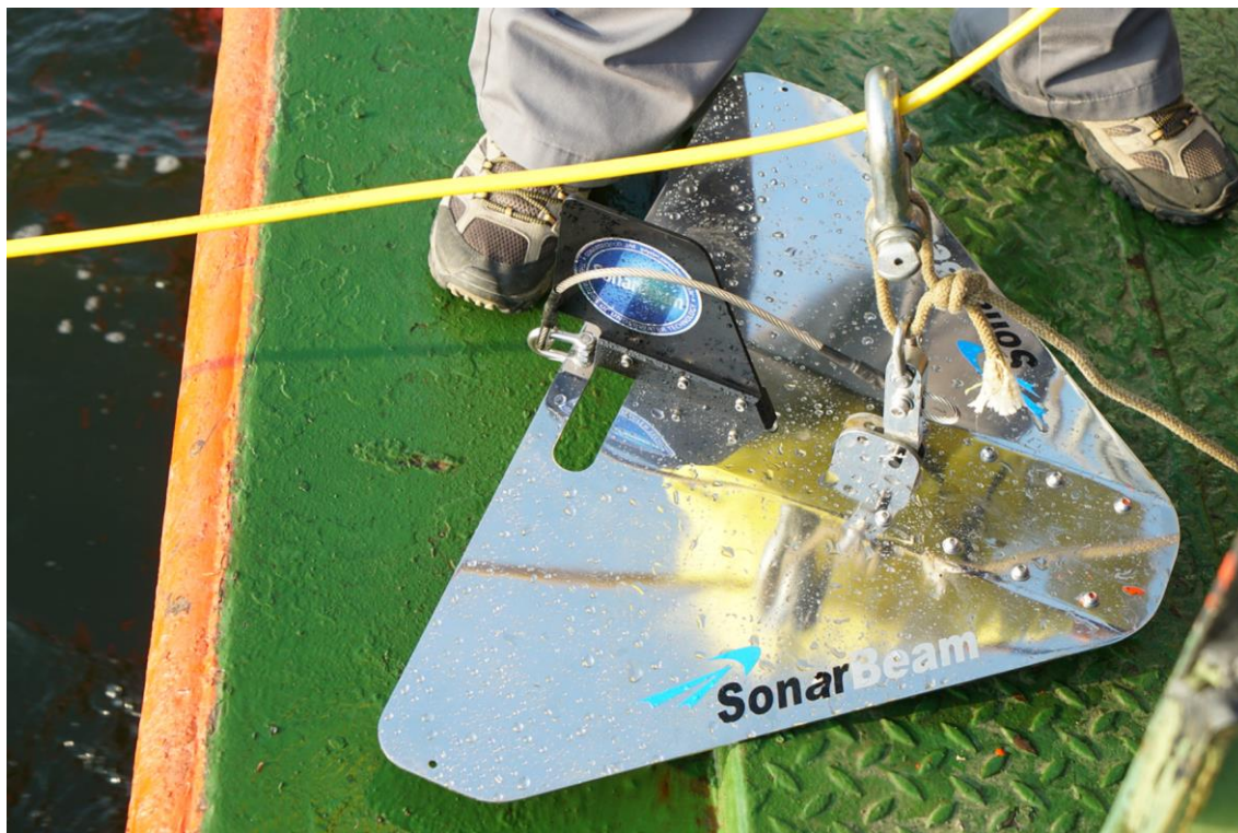
Илл. 18. Морской отгрузочный терминал. Крыло-депрессор.
