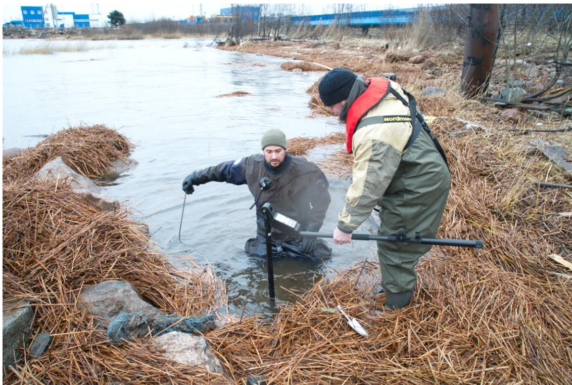
Илл. 31. Морской отгрузочный терминал. Участок МОТ. Водолазное обследование выявленных объектов. Уточнение места аномалии градиентометром Ferex 4.035API.
