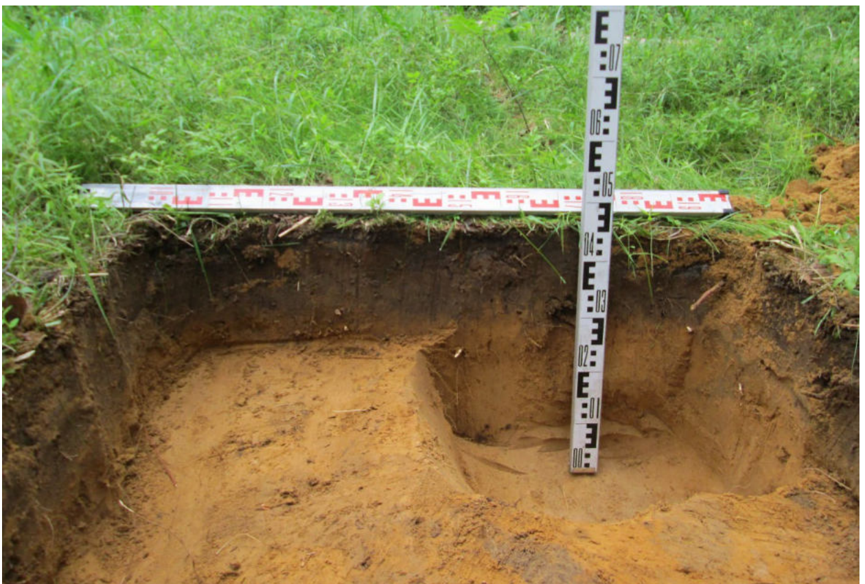
Илл. 90. Ленинградская область, Всеволожский район. Трасса проектируемой реконструкции автомобильной дороги А-181. Шурф 6. Северная стенка и контрольный прокоп. Вид с юга. Для масштаба использованы нивелировочные рейки длиной 2 м.
