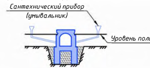
Продольный разрез конструкций отхожего места
